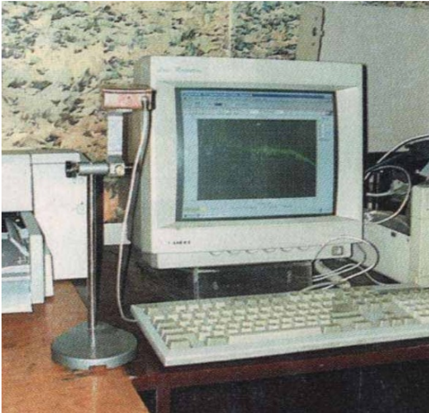
Photo XV: La caractéristique fréquence-amplitude du signal de torsion reçu, présentée sur écran.
