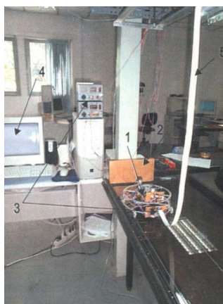
Photo II: Stand d'expérimentation du choc élastique entre gyroscope quadridimensionnel et un mur.
